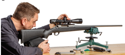
Visuelles Ausrichten eines Zielfernrohrs durch den Lauf
